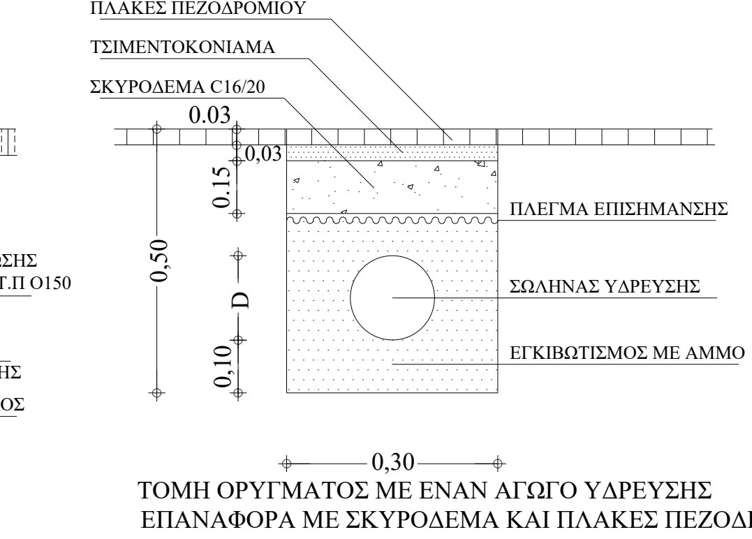
ΤΟΜΗ ΟΡΥΓΜΑΤΟΣ ΜΕ ΕΝΑΝ ΑΓΩΓΟ ΥΔΡΕΥΣΗΣ ΕΠΑΝΑΦΟΡΑ ΜΕ ΣΚΥΡΟΔΕΜΑ
